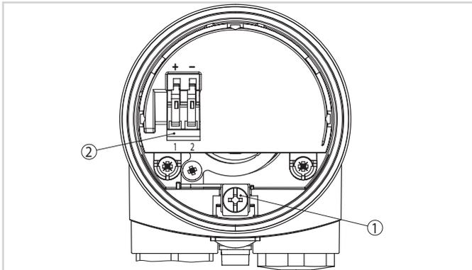
Compartimento de la electrónica y de conexión, carcasa de una cámara
