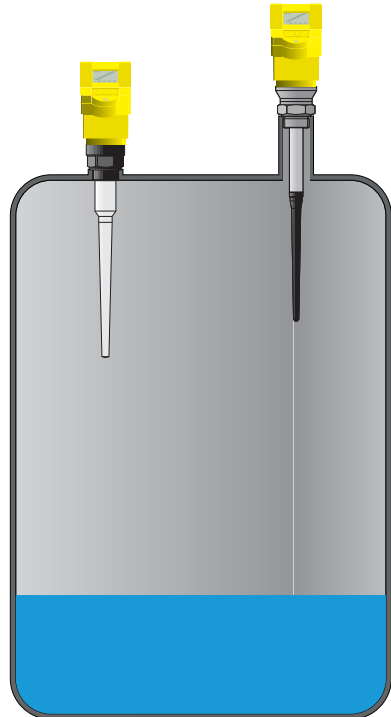
Abb. 6.4: Typische Einbau einer Stabantenne: Der aktive konische Teil der Antenne muss komplett in den Behälter ragen. Für längere Stutzen sollten Antennen mit inaktiver Länge verwendet werden.
