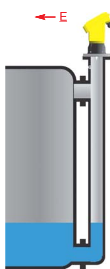
Abb. 6.21: Polarisationsrichtung bei einem Bypassrohr.
