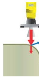
Abb. 6.30: Die Messung über einem angeschrägten Bereich des Behälterdeckels verbessert die Messung deutlich.
