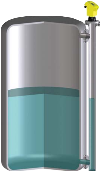
Abb. 6.20: Position von Entlüftungsbohrung und Polarisierung auf einem Standrohr.
