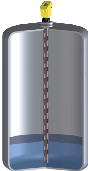
Abb. 6.23: Durch Schlitze wird eine gute Durchmischung von inhomogenen Produkten erreicht. Die Polarisation muss in Richtung der Schlitze ausgerichtet werden.
