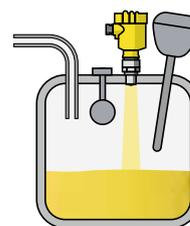
Con un diseño compacto y conexiones a proceso a partir de ¾" de rosca, el VEGAPULS 64 se puede utilizar en depósitos pequeños.
