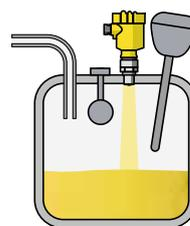
La struttura compatta del sensore e gli attacchi di processo con filettatura a partire da ¼" rendono possibile l'impiego del VEGAPULS 64 in serbatoi di piccole dimensioni.
