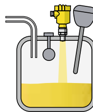
通过其紧凑的传感器构造和螺纹从 ¾" 起的过程连接，VEGAPULS 64 可以用于小型容器。
