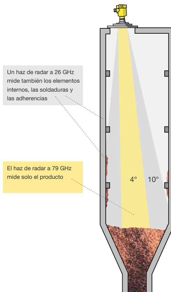
Un haz de radar a 26 GHz mide también los elementos internos, las soldaduras y las adherencias
