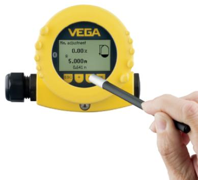
Operación mediante lápiz magnético con la tapa del sensor cerrada.
