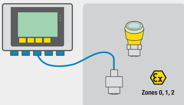
Le capteur est alimenté par un circuit à sécurité intrinsèque.
