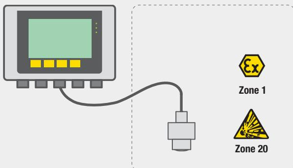
La protection contre les explosions est assurée en encapsulant tous les composants électriques et le câble de raccordement.
