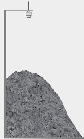
Os sensores de radar VEGAPULS medem o nível de forma precisa e sem contato – mesmo sob condições extremas na indústria de materiais de construção. Ângulos de empilhamento do material variados, formação de pó, aderências ou ruído não interferem no resultado da medição. Os sensores robustos garantem a disponibilidade do material, a qualquer momento e de forma inteiramente confiável.
