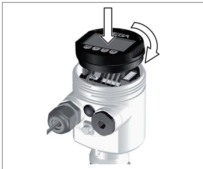
Figura 5: Installare il tastierino di taratura con display
