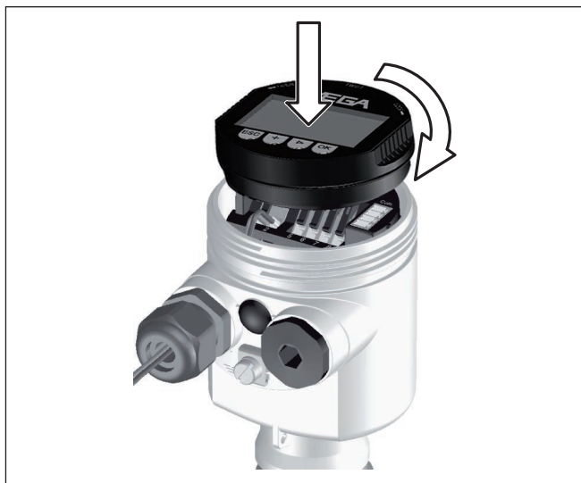
Figura 5: Installare il tastierino di taratura con display
