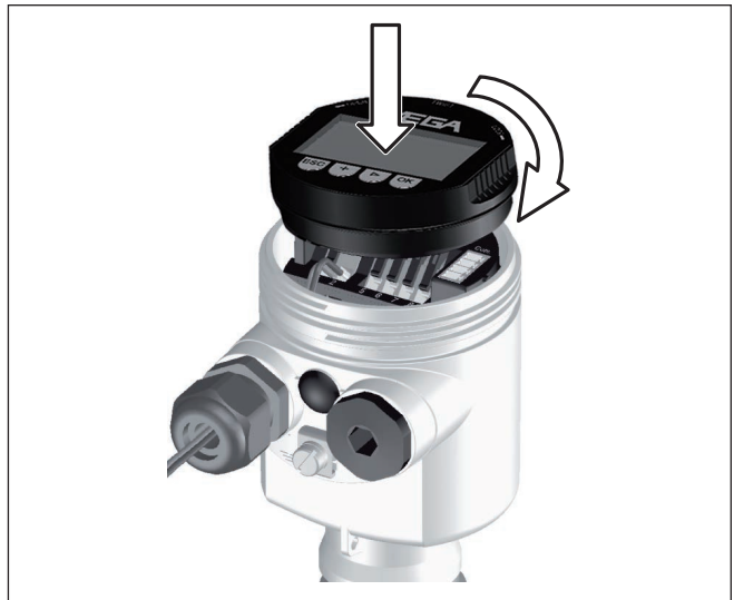
Fig. 7: Insertion du module de réglage et d'affichage
