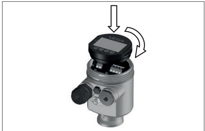
Fig. 7: Empleo del módulo de visualización y configuración en carcasa de una sola cámara el compartimento de conexión
