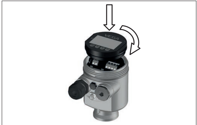
Fig. 7: Empleo del módulo de visualización y configuración en carcasa de una sola cámara el compartimiento de conexión
