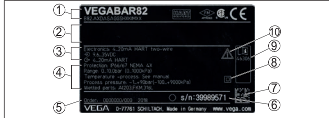
Fig. 1: Estructura de la placa de tipos (ejemplo)
