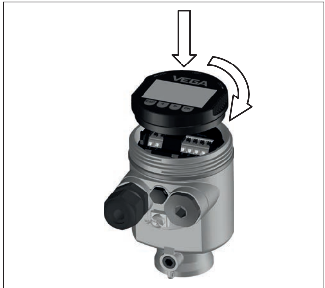
Figura 6: Inserimento del tastierino di taratura con display nel vano dell'elettronica in caso di custodia ad una camera
