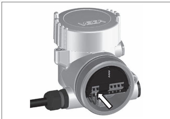
Figura 3: Operazioni di collegamento 5 e 6
