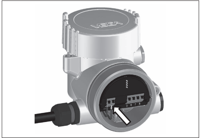
插图. 7: 连接步骤 5 和 6 - 两腔式壳体
