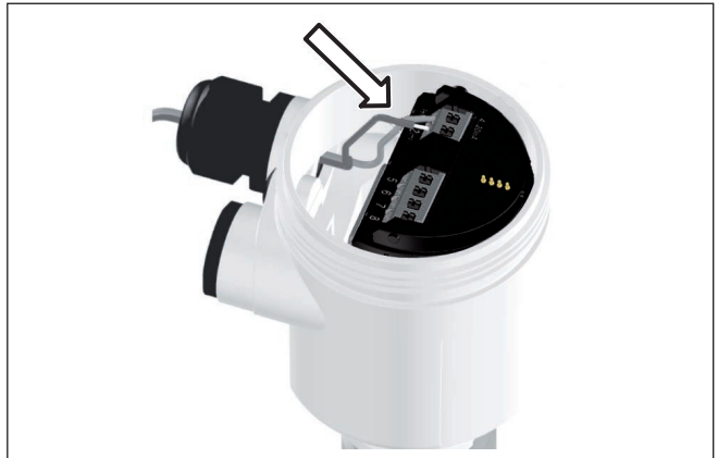
插图. 6: 连接步骤 5 和 6 - 单腔式壳体
