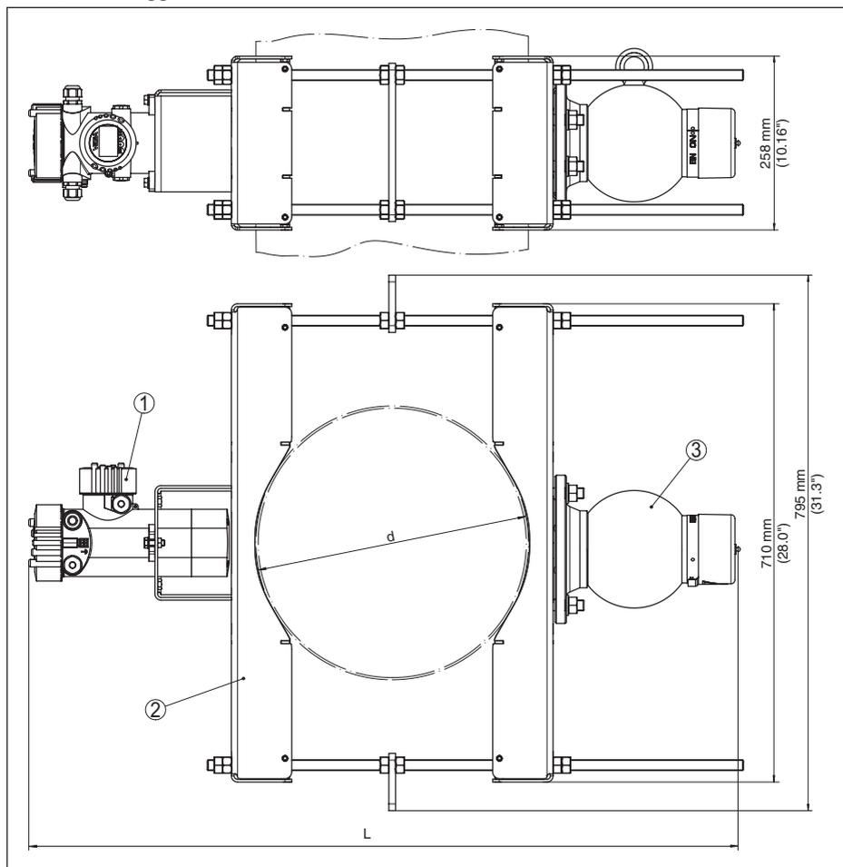
Figura 7: Dispositivo di fissaggio con sensore montato orizzontalmente
