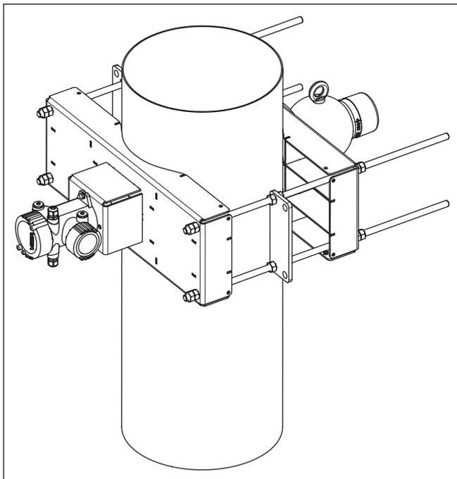
*Figura 1: Dispositivo di fissaggio con sensore montato orizzontalmente*
