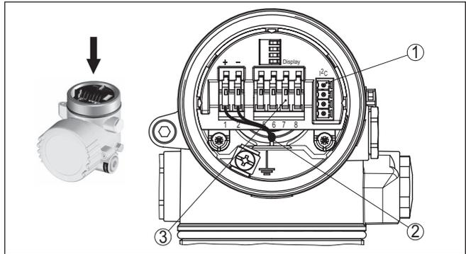
Abb. 16: Elektronikraum - Zweikammergehäuse
