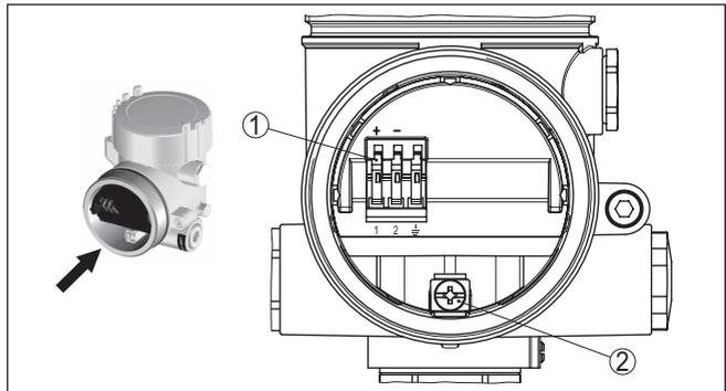
Abb. 17: Anschlussraum - Ex d ia-Zweikammergehäuse
