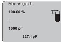
1. Mit **[OK]** den Abgleichwert zum Editieren vorbereiten. Mit **[OK]** in das Auswahlfenster wechseln.
