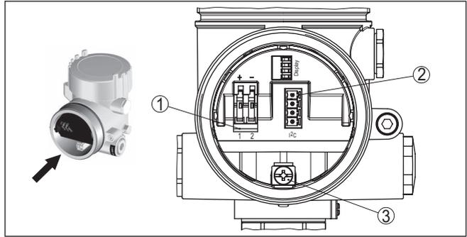
Abb. 13: Anschlussraum - Zweikammergehäuse
