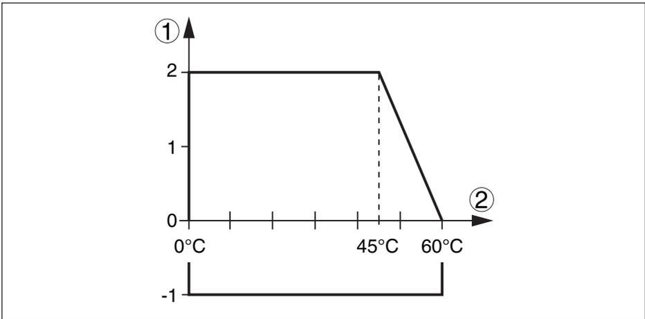
Abb. 28: Prozessdruck - Prozesstemperatur (Flansch aus PP)
