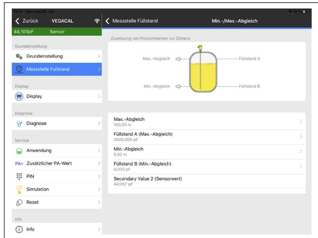
Abb. 26: Beispiel einer App-Ansicht - Inbetriebnahme Sensorabgleich
