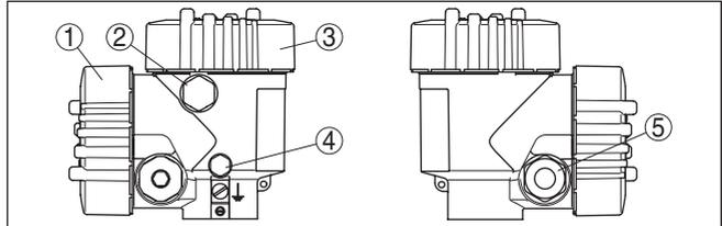
Abb. 11: Zweikammergehäuse
