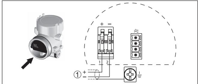
Abb. 14: Anschlussplan - Zweikammergehäuse
