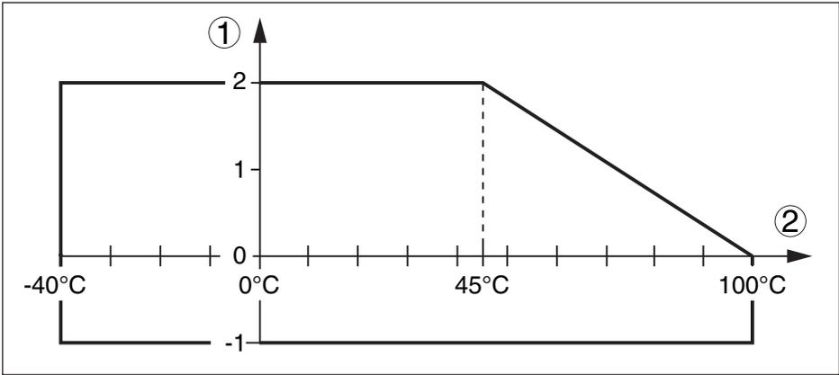
Abb. 27: Prozessdruck - Prozesstemperatur (Flansch aus PTFE)
