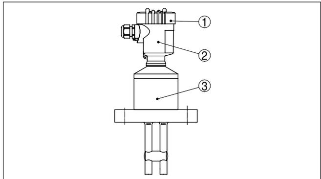
Abb. 1: VEGACAL 69 - Zweistabmesssonde mit Kunststoffgehäuse
