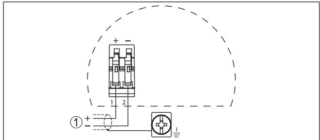
Abb. 10: Anschlussplan - Einkammergehäuse
