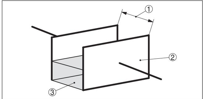
Abb. 3: Funktionsprinzip - Plattenkondensator
