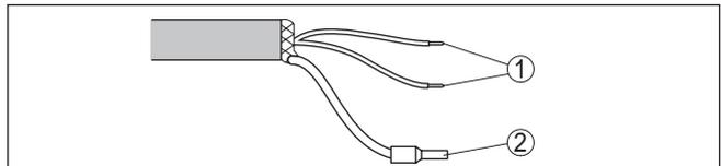
Abb. 11: Aderbelegung Anschlusskabel
