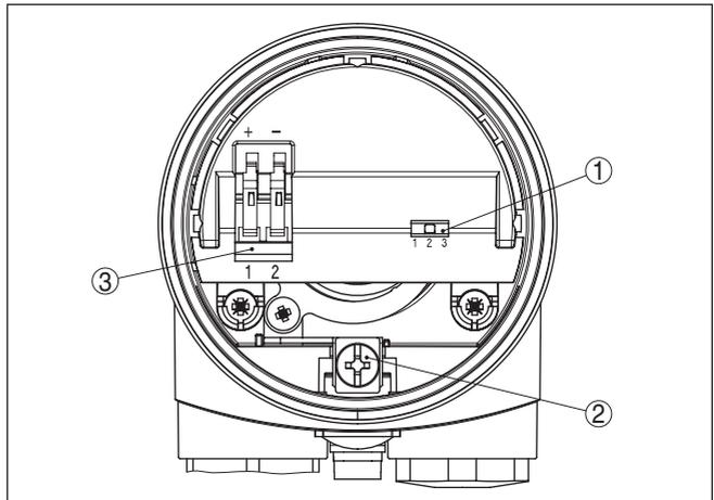
Abb. 12: Anzeige- und Bedienelemente - Elektronikeinsatz
