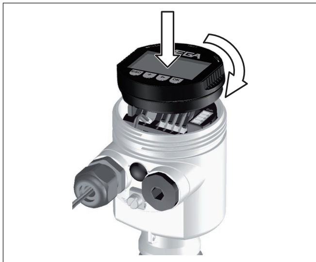
Figura 16: Inserimento del tastierino di taratura con display nella custodia a una camera
