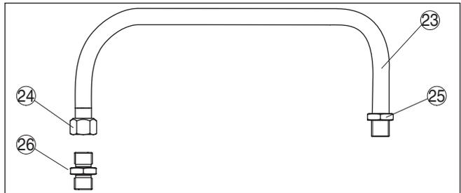
Fig. 9: Flexible de réfrigérant préconfectionné
