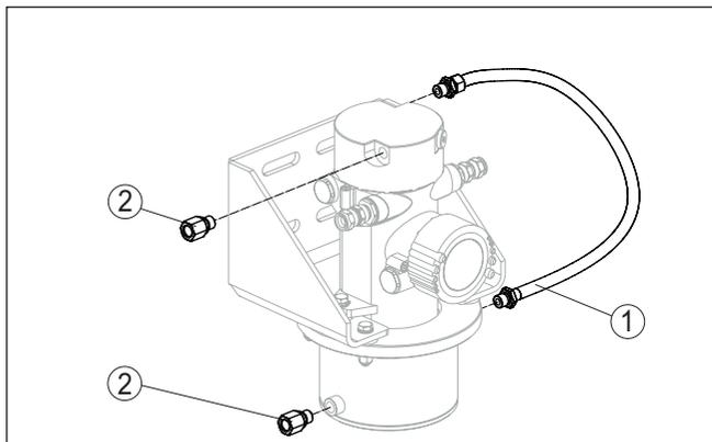
Figura 10: Raffreddamento dello scintillatore - tubi flessibili e adattatori
