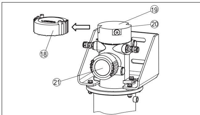
Figura 6: Montaggio del coperchio di raffreddamento della custodia
