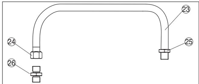
Abb. 16: Vorkonfektionierter Kühlmittelschlauch
