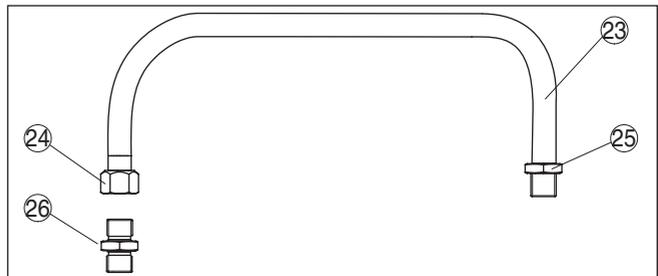
Fig. 16: Flexible de réfrigérant préconfectionné
