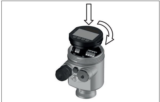
Fig. 23: Montage du module d'affichage et de réglage dans le boîtier à chambre unique se trouvant dans le compartiment de l'électronique
