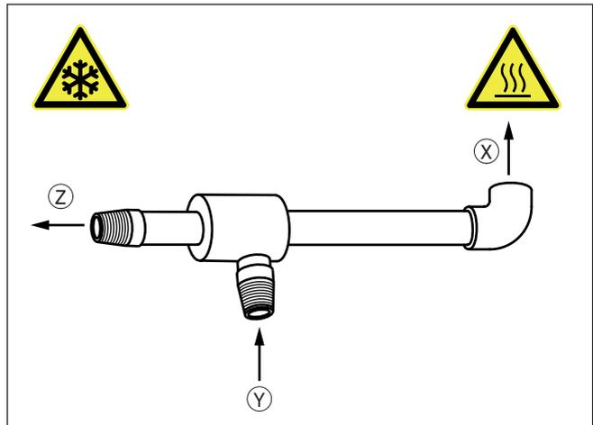
Fig. 8: Refroidisseur à courant tourbillonnaire (refroidisseur à cyclone)
