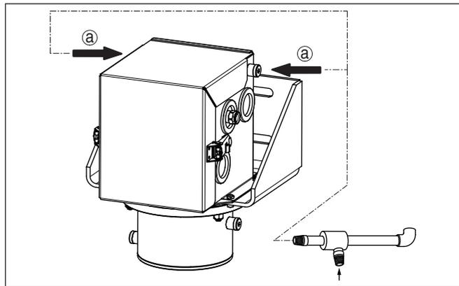
Fig. 9: Raccordement du système d'air de refroidissement (refroidisseur à courant tourbillonnaire)
