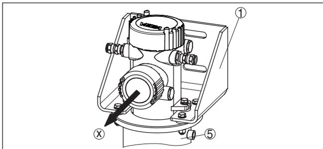
Fig. 6: Sens de montage du capteur sur l'équerre de fixation
