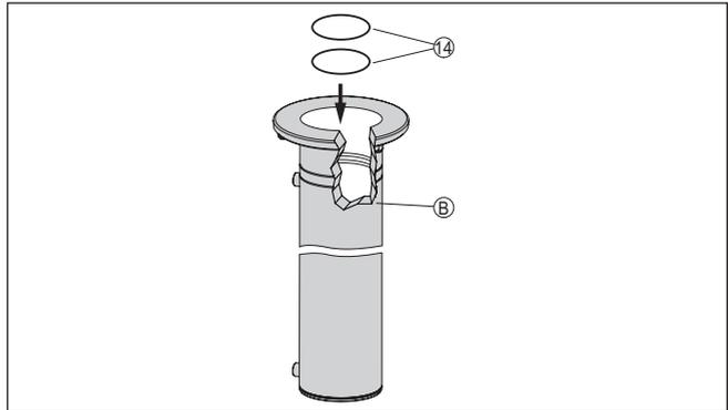
Fig. 2: Insertion des anneaux d'étanchéité dans le refroidissement du scintillateur
