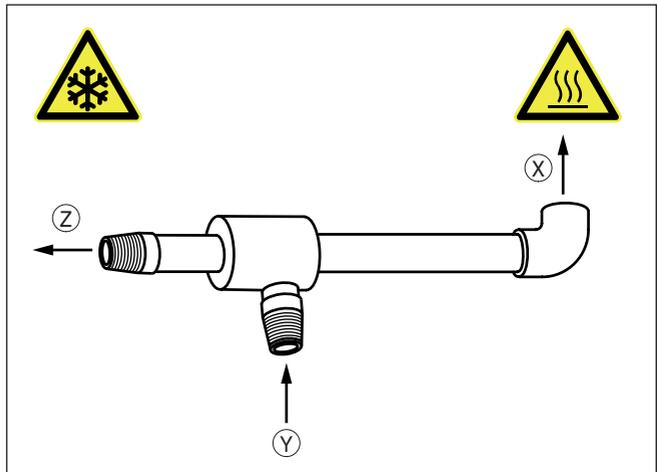
Fig. 13: Refroidisseur à courant tourbillonnaire (refroidisseur à cyclone)
