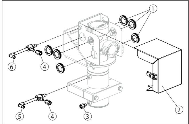
Fig. 16: Pièces de rechange - refroidissement par air SOLITRAC, POINTRAC
