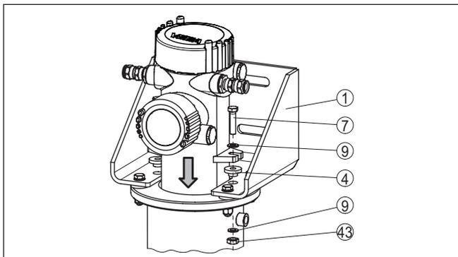
Fig. 7: Montage du capteur - SOLITRAC, POINTRAC
