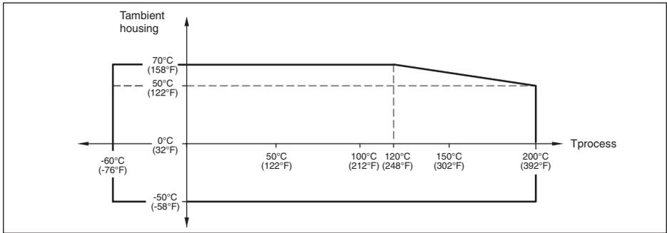
**Ausführungen für Prozesstemperaturen bis +250 °C mit Kunststoffgehäuse**
