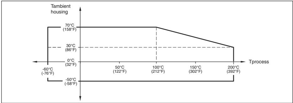
**Ausführungen für Prozesstemperaturen bis +200 °C mit Metallgehäuse**
