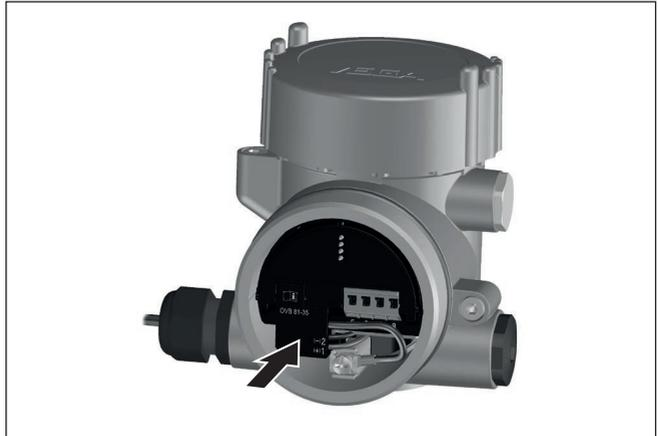
Fig. 4: Enfiler l'appareil de protection contre les surtensions sur l'électronique du capteur - Boîtier à deux chambres
