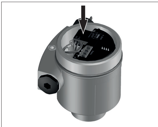
Рис. 3: Установка защиты от перенапряжений на электронике датчика в алюминиевом однокамерном корпусе
