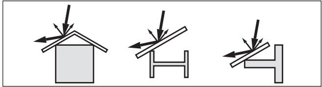
Fig. 23: Recouvrir les obstacles lisses par des déflecteurs
