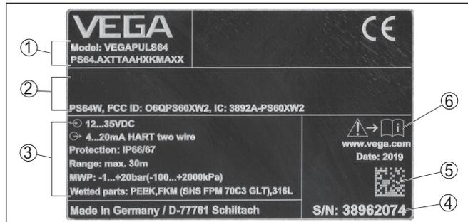
Fig. 1: Présentation de la plaque signalétique (exemple)
