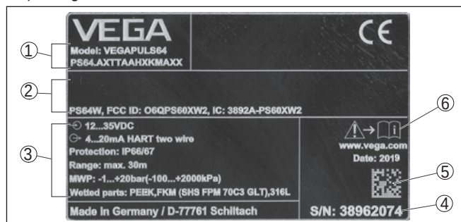
Fig. 1: Opbouw van de typeplaat (voorbeeld)
