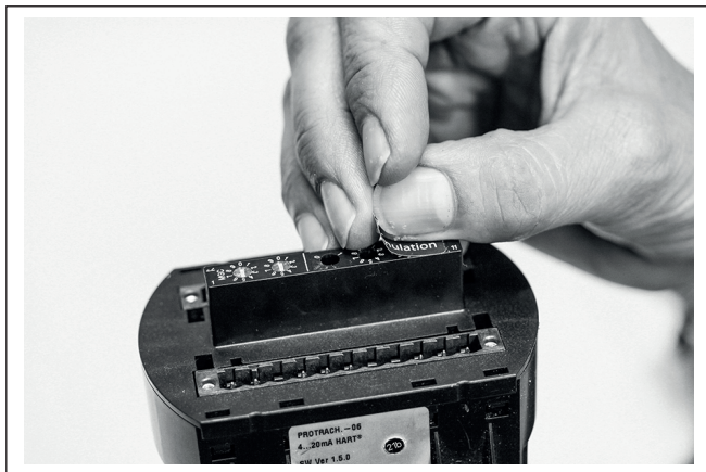
Abb. 2: Profibus PA - Abdeckfolie über den Adresswahlschaltern abziehen
