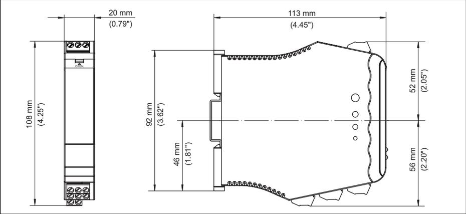
Fig. 7: Medidas VEGATOR 131
