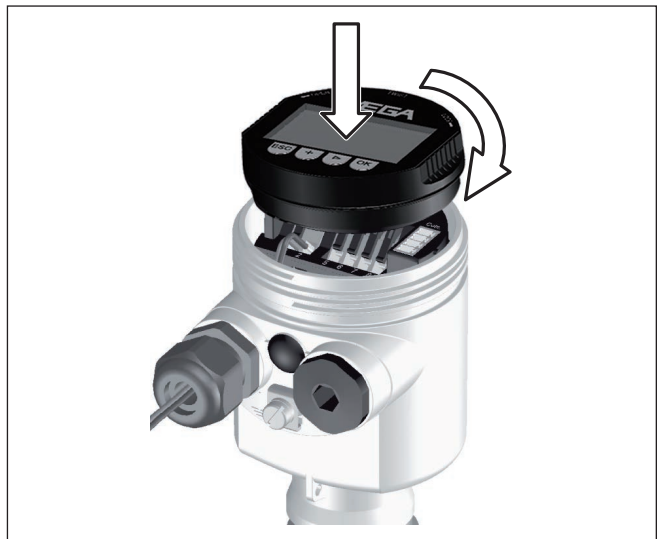
Abb. 5: Anzeige- und Bedienmodul einsetzen
