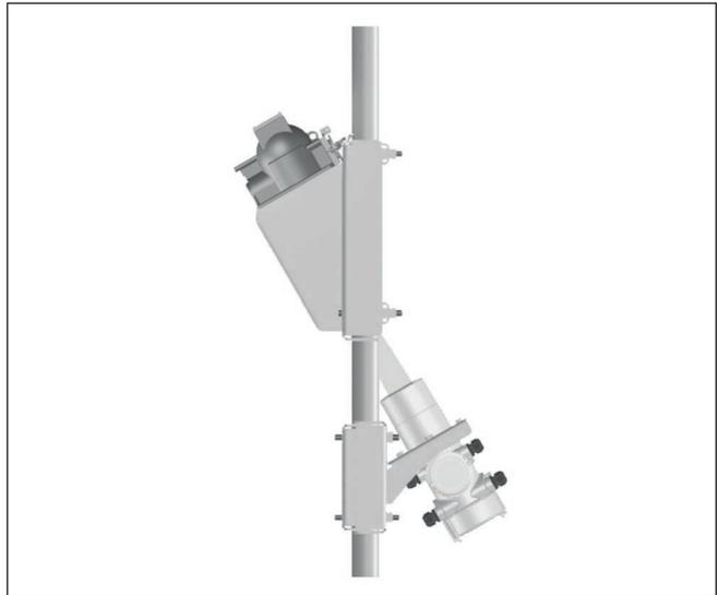
Abb. 11: 30°-Messanordnung an einer Rohrleitung mit Durchmesser 50 ... 100 mm (1.97 ... 3.94 in)
