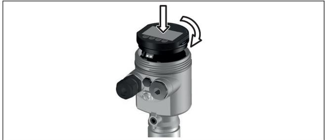
Abb. 32: Einsetzen des Anzeige- und Bedienmoduls beim Einkammergehäuse im Elektronikraum
