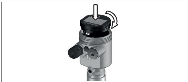
Fig. 31: Empleo del módulo de visualización y configuración en carcasa de una sola cámara el compartimiento de conexión
