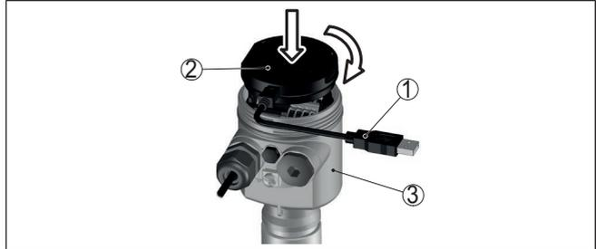
Abb. 44: Anschluss des PCs via Schnittstellenadapter direkt am Sensor
