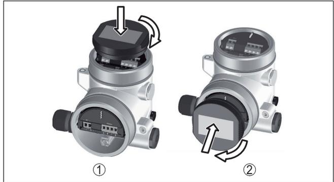
Abb. 6: Einsetzen des Anzeige- und Bedienmoduls beim Zweikammergehäuse
