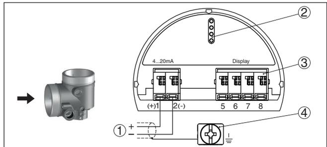
Abb. 4: Anschlussraum - Zweikammergehäuse
