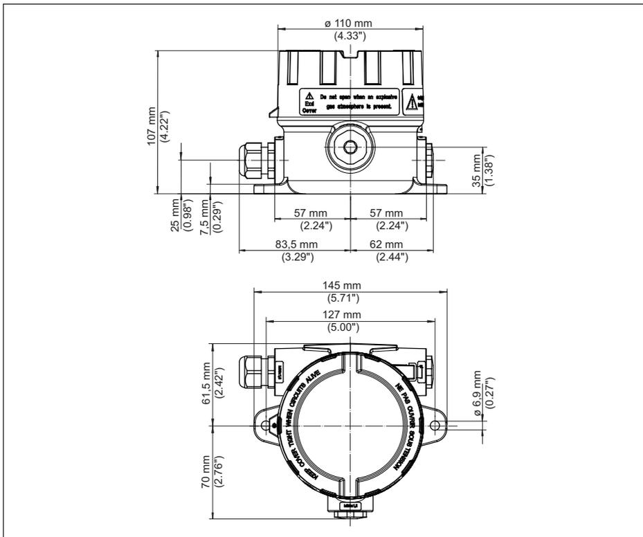
Figura 13: Dimensioni PLICSMOBILE B81 con custodia in alluminio
