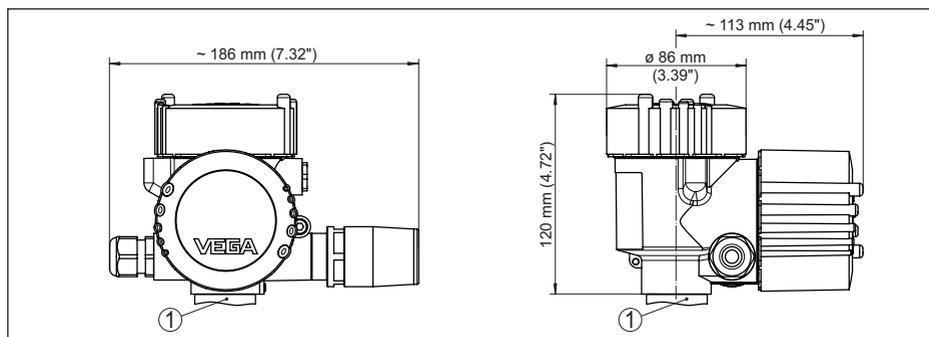
Figura 12: Dimensioni PLICSMOBILE 81 con custodia VA/alluminio
