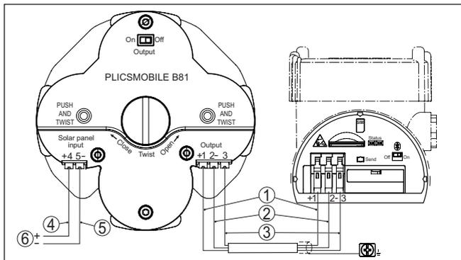
Figura 4: Collegamento della batteria e del modulo solare
