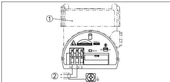
Figura 3: Collegamento della tensione d'alimentazione di Plicsmobile 81
