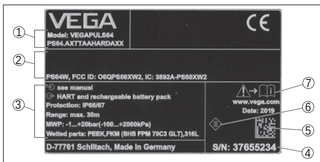
Fig. 1: Opbouw van de typeplaat (voorbeeld)
