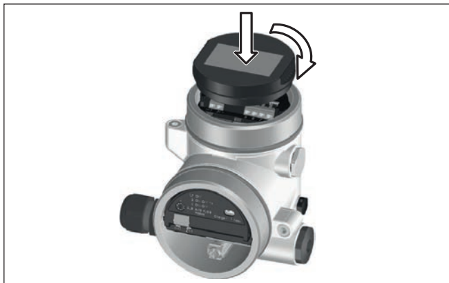
Fig. 32: Plaatsen van de display- en bedieningsmodule
