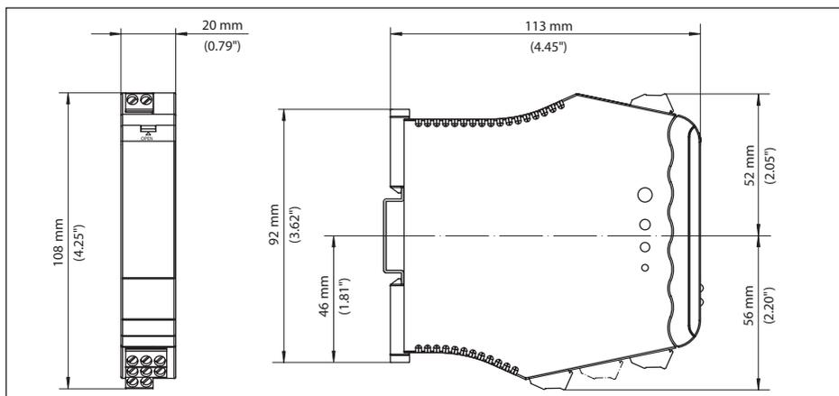
Fig. 6: Encombrement VEGATOR 121
