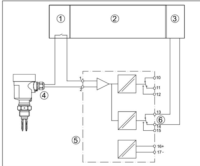
Fig. 3: Test de fonctionnement automatisé via un relais de défaut et l'API
