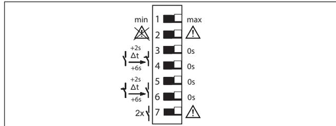
Fig. 2: Commutateur DIL VEGATOR 121
