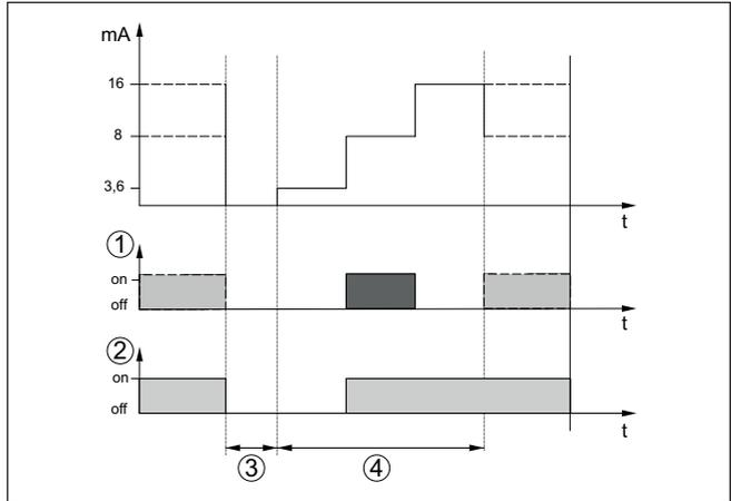
Fig. 4: Diagramme de déroulement d'une impulsion d'activation correcte
