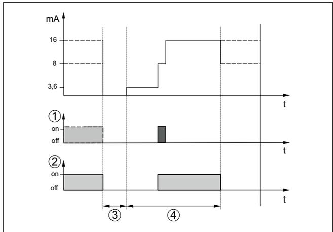
Fig. 5: Diagramme de déroulement d'une impulsion d'activation incorrecte
