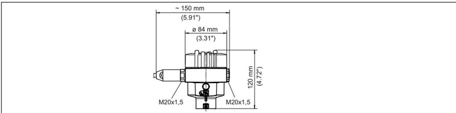
Abb. 36: Gehäuseausführungen in Schutzart IP66/IP68 (1 bar), (mit eingebautem Anzeige- und Bedienmodul vergrößert sich die Gehäusehöhe um 18 mm/0.71 in)
