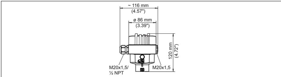
Abb. 33: Gehäuseausführung in Schutzart IP66/IP68 (0,2 bar), (mit eingebautem Anzeige- und Bedienmodul vergrößert sich die Gehäusehöhe um 18 mm/0.71 in)
