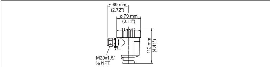
Abb. 32: Gehäuseausführung in Schutzart IP66/IP67 (mit eingebautem Anzeige- und Bedienmodul vergrößert sich die Gehäusehöhe um 9 mm/0.35 in)
