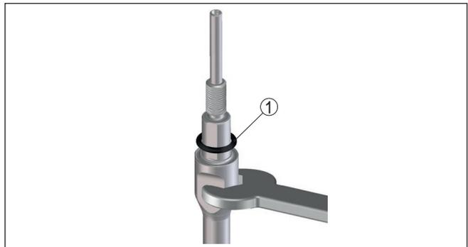
Abb. 25: Messstab wechseln
