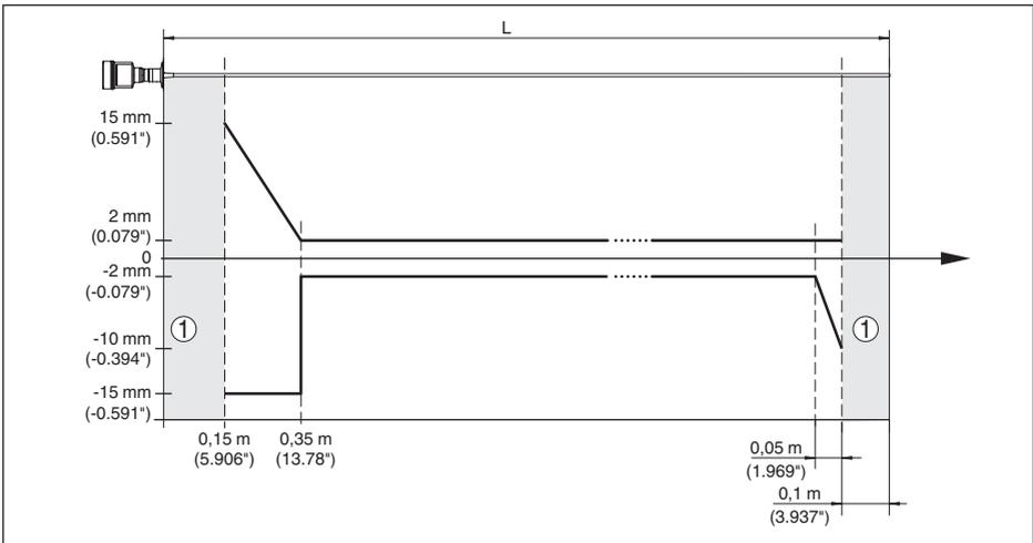
Abb. 30: Messabweichung VEGAFLEX 83 in Stabausführung in Medium Öl
