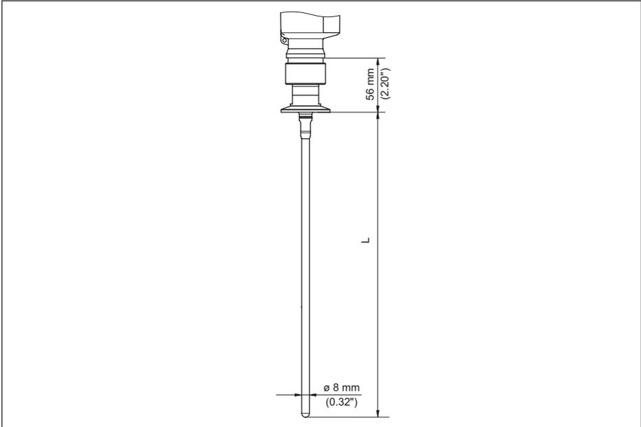
Abb. 37: VEGAFLEX 83, Stabausführung  $\varnothing$  8 mm (0.315 in), poliert
