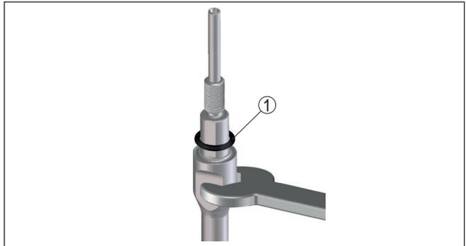
Abb. 26: Messstab ausbauen
