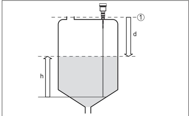
Abb. 1: Füllstandmessung
