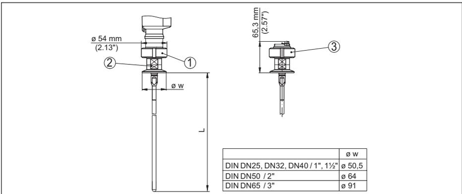
Abb. 38: VEGAFLEX 83, Stabausführung  $\varnothing$  8 mm (0.315 in), poliert - Autoklavierbare Ausführung
