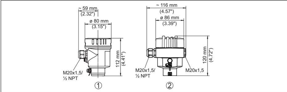
Abb. 35: Gehäuseausführungen in Schutzart IP66/IP68 (0,2 bar), (mit eingebautem Anzeige- und Bedienmodul vergrößert sich die Gehäusehöhe um 18 mm/0.71 in)
