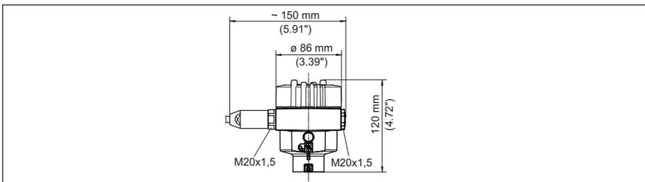
Abb. 34: Gehäuseausführung in Schutzart IP66/IP68 (1 bar), (mit eingebautem Anzeige- und Bedienmodul vergrößert sich die Gehäusehöhe um 18 mm/0.71 in)
