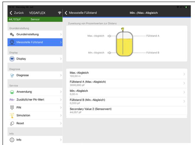
Abb. 18: Beispiel einer App-Ansicht - Inbetriebnahme Sensorabgleich
