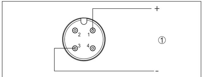
插图. 15: 接线图 - 两线制 4 ... 20 mA - M12 x 1 插头
