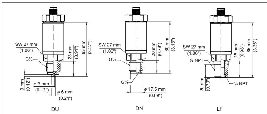
插图. 19: VEGABAR 19, 螺纹, 非正面齐平式
