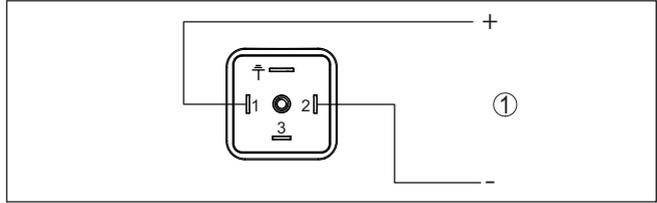
插图. 16: 接线图 - 两线制 4 ... 20 mA 插头, 符合 ISO 4400 标准
