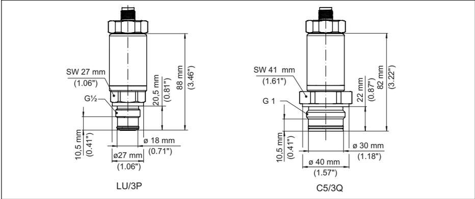
插图. 20: VEGABAR 19, 螺纹接头非正面齐平式
