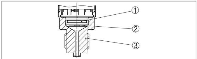
插图. 5: 缩后式安装测量元件 (举例：螺纹 G $\frac{1}{2}$ , EN 837 压力计接口)
