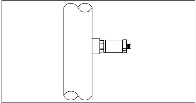
插图. 3: 用 VEGABAR 19 测量过程压力
