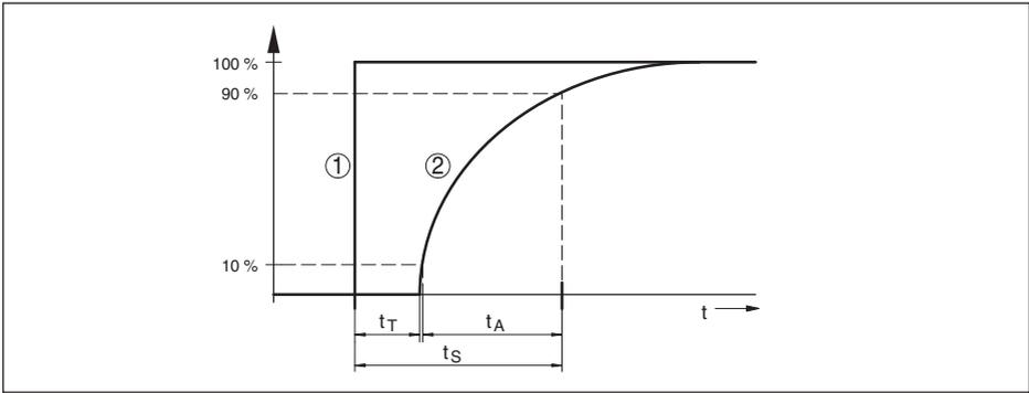
插图. 17: 出现过程值跳跃式变化时电流输出的表现。t<sub>T</sub>: 停滞时间; t<sub>A</sub>: 上升时间; t<sub>S</sub>: 跳跃式响应时间
