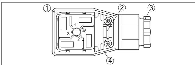
Figura 13: Rimozione dell'unità di connessione
