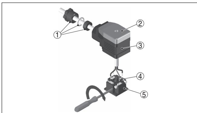
Figura 14: Collegamento ai morsetti a vite
