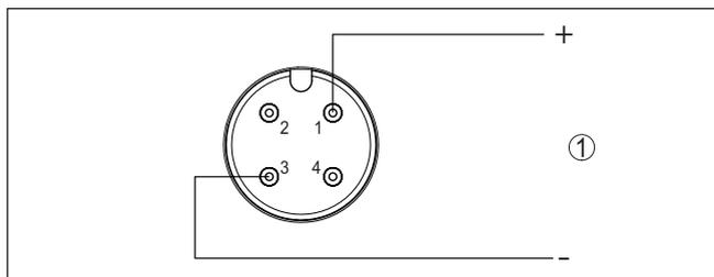
Figura 15: Schema di collegamento - bifilare 4 ... 20 mA - connettore M12 x 1
