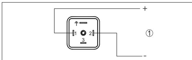
Figura 16: Schema di collegamento - bifilare 4 ... 20 mA - connettore conforme a ISO 4400
