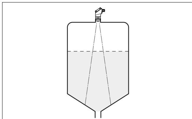
插图. 8: 将雷达传感器安装到带有锥形底部的容器上
