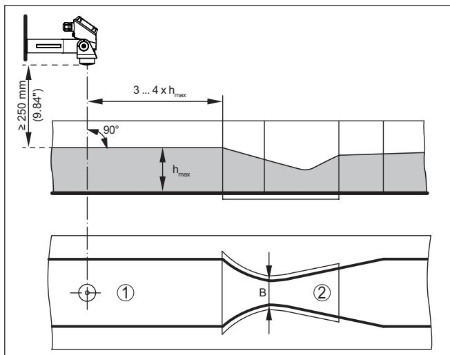
插图. 16: 用卡发基-文丘里槽来测量流量 :  $h_{\max}$  = 水槽的最大灌装量 ; B = 水槽的最大收缩率
