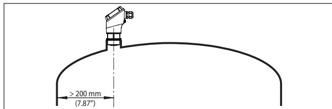
插图. 7: 将雷达传感器安装在圆形容器盖上
