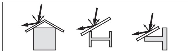
插图. 12: 用散射挡板来覆盖光滑的型材
