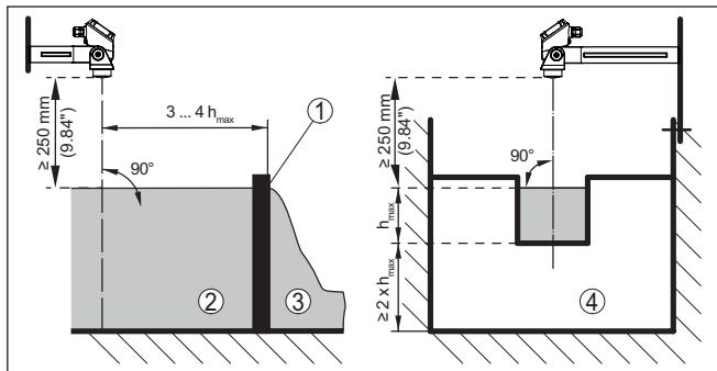
插图. 15: 用矩形槽测量流量 :  $h_{\max}$  = 矩形槽的最大注水高度
