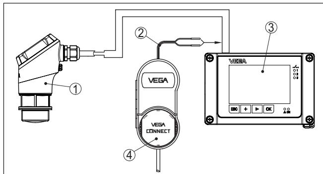
插图. 28: 将电脑与 VEGAMET 型控制器相连接
