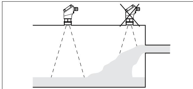
插图. 9: 流入介质时安装雷达传感器
