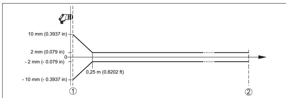
插图 35: 在基准条件下的测量偏差<sup>10)</sup>
