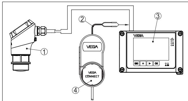
插图. 30: 将电脑与 VEGAMET 型控制器相连接
