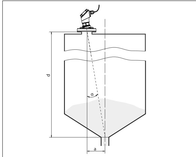
插图. 15: 校准 VEGAPULS 31 后的安装建议
