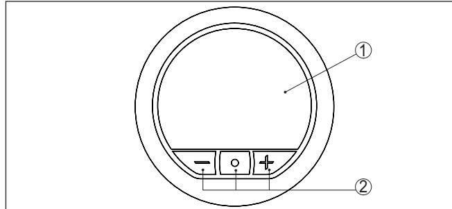
插图. 21: 内置的显示和调整单元上的元件
