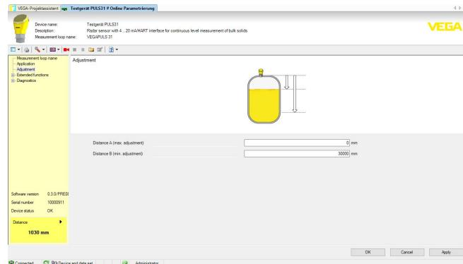
插图. 28: DTM 视图举例 - 调试 传感器调整
