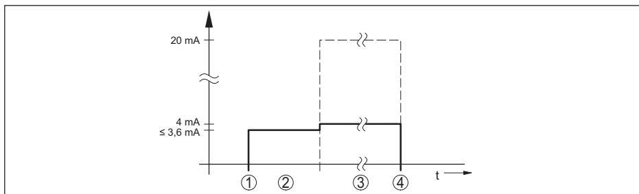
插图. 34: 启动时间和测量值的输出
