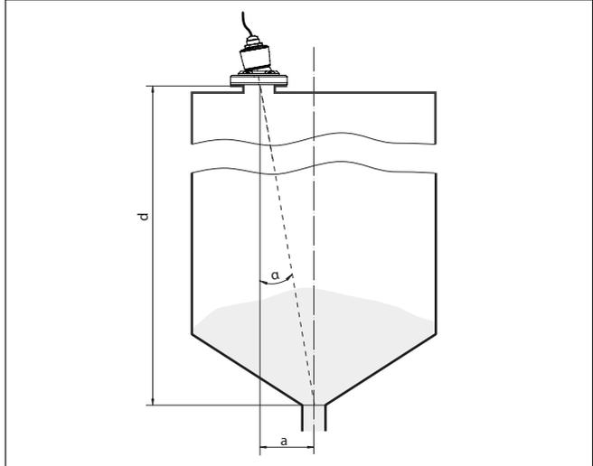
Abb. 16: Vorschlag für den Einbau nach Ausrichtung VEGAPULS C 21
