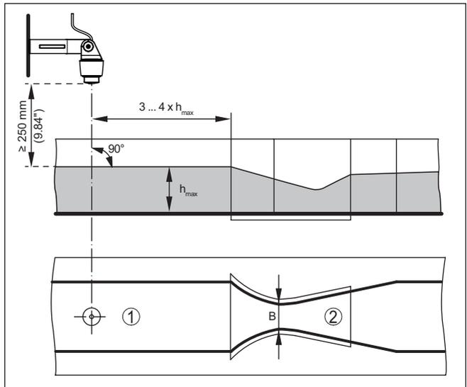
Abb. 19: Durchflussmessung mit Khafagi-Venturirinne:  $h_{max.} = \text{max. Befüllung der Rinne}$ ; B = größte Einschnürung der Rinne
