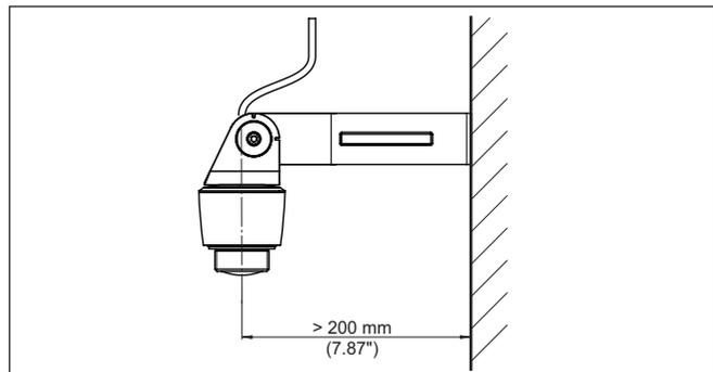
Abb. 5: Montage über einen Montagewinkel
