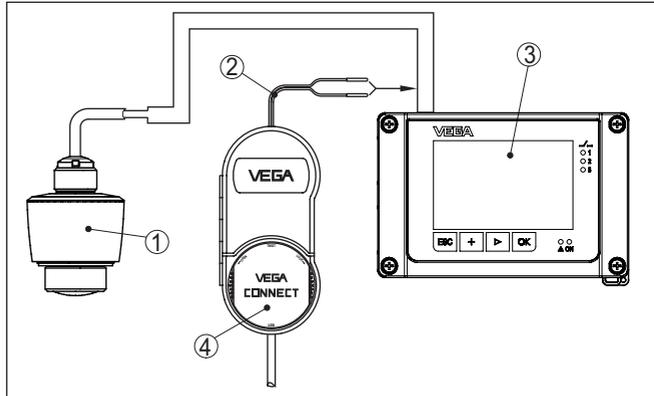
Abb. 26: Anschluss des PCs an das Steuergerät VEGAMET
